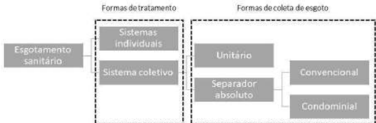
Figura II.2 - Variantes dos sistemas de esgotamento sanitário
