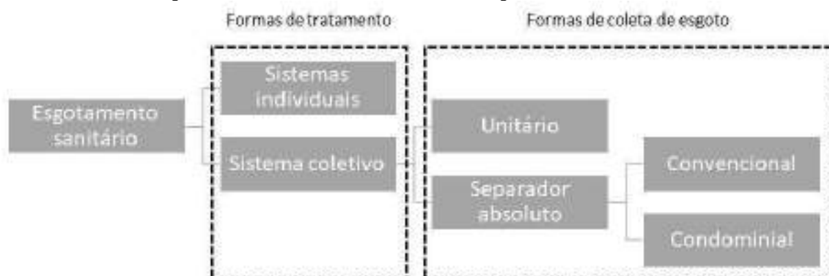
Figura 5-1 – Variantes dos sistemas de esgotamento sanitário
