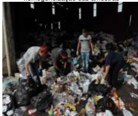
Figura IV-69: Rompimento manual para a homogeneização das amostras
