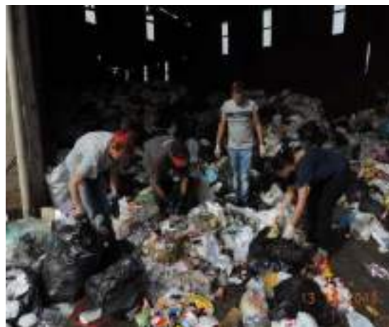
Figura 6-5: Rompimento manualmente para a homogeneização das amostras (Fonte: Prefeitura Municipal de Ivoti)
