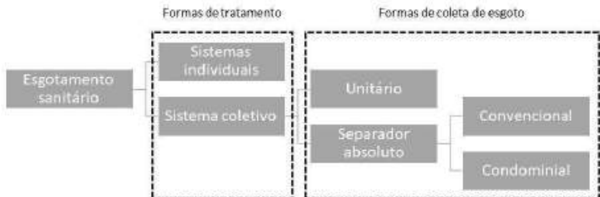
Figura II.2 - Variantes dos sistemas de esgotamento sanitário
